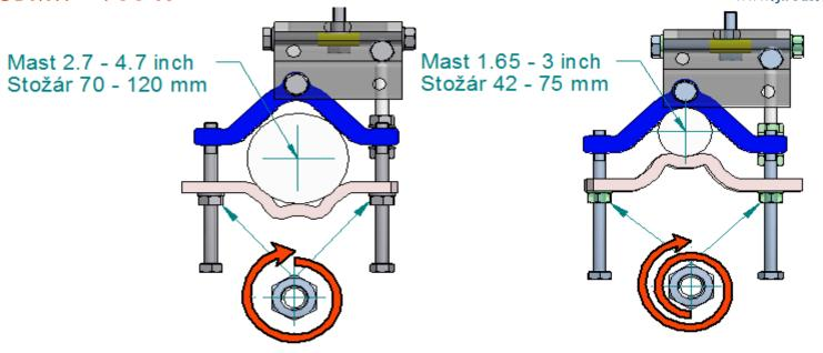
Tighten with tool Utáhnout nástrojem 1x 360° Tighten with tool Utáhnout nástrojem 1x 360° + 180°
